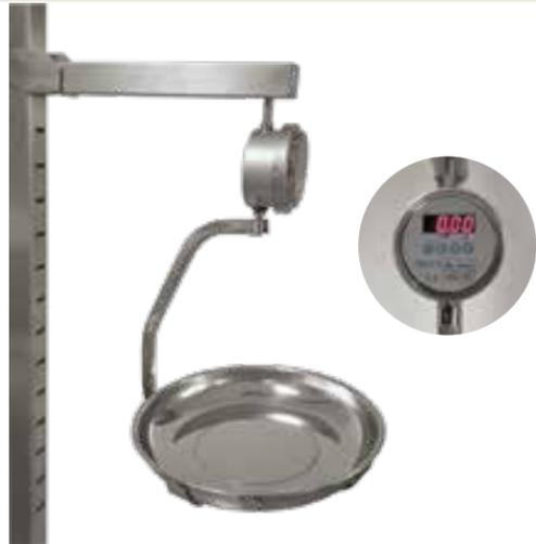
**Organwaage, Hängeformat.** Auflösung: 3000 div. auf Skalenendwert. Anzeige: 4 digitale LED Höhe 14 mm. Stromversorgung: wiederaufladbare Batterien. Autonomie: 36 Stunden. Funktionen: Null Tara, Peak, Auto Off. Gehäuse: Edelstahl - AISI 304. Innenteile: Edelstahl. Anschlüsse: Drehbare Augenschrauben aus Edelstahl. Optional mit stabilem Ständer aus Edelstahl.
