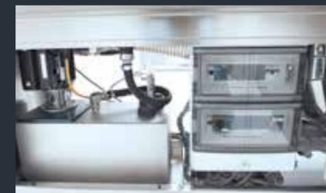
**Ausgussbecken für Alt-Lösemittel** (in verschiedenen Ausführungen) und **Absaug- und Abpumpstation mit Druckluft-Membranpumpe** zum Einbau in vorhandenen Unterbau. Um das Entstehen explosiver Luft-Gas-Gemische zu vermeiden werden Alt-Lösungsmittel direkt in den zentralen Sammel tank gepumpt.
