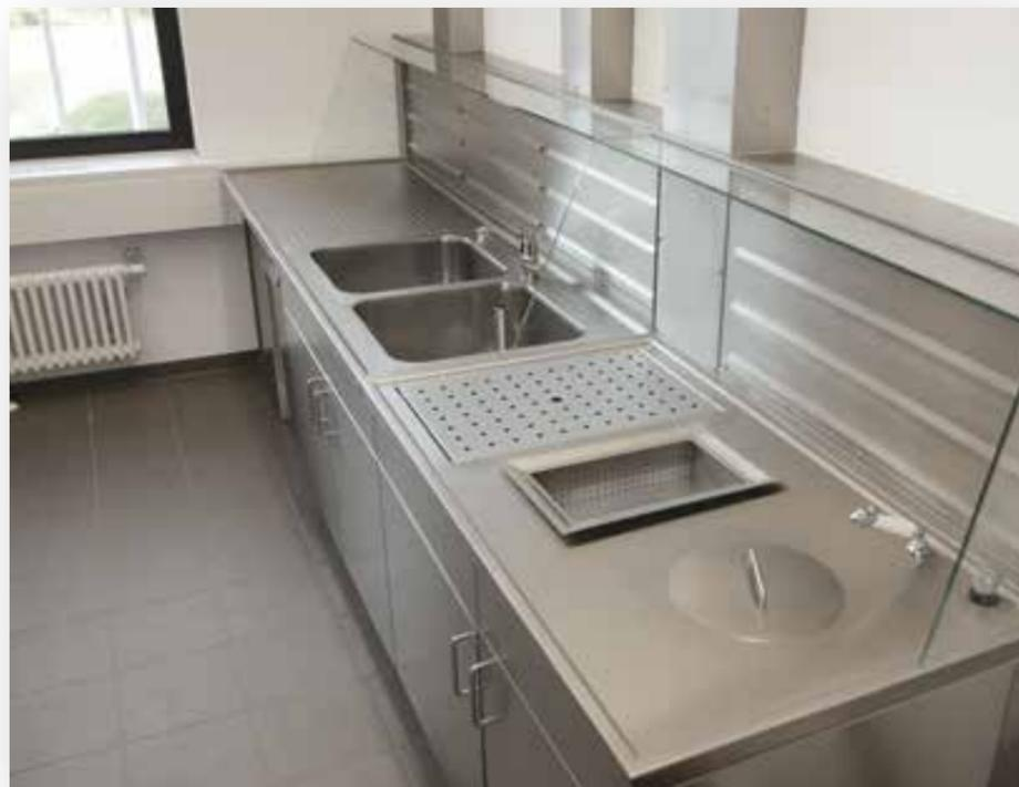
**Modulare Arbeitstischanlagen.** Aus hochwertigem Edelstahl (1.4301) gefertigt, Oberfläche gebürstet für reflexfreies Finish und optimale Reinigung. Integrierte, abgesaugte Arbeitsflächen, wahlweise perforiert oder mit umlaufender Randabsaugung. Unterbauten mit Schubladen, Türen und Schließsystemen sowie Regalanlagen und Hängeschränke können individuell angepasst und intergriert werden. Bitte kontaktieren Sie uns für ein individuell auf Ihre Bedürfnisse zugeschnittenes Angebot.
