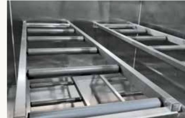
**Sargregale.** Diese speziell konzipierten und höhenverstellbaren Regale bieten einfache Lagerungsmöglichkeiten für Särge in Kühlzellen mit großen Türen oder Kühlräumen.
